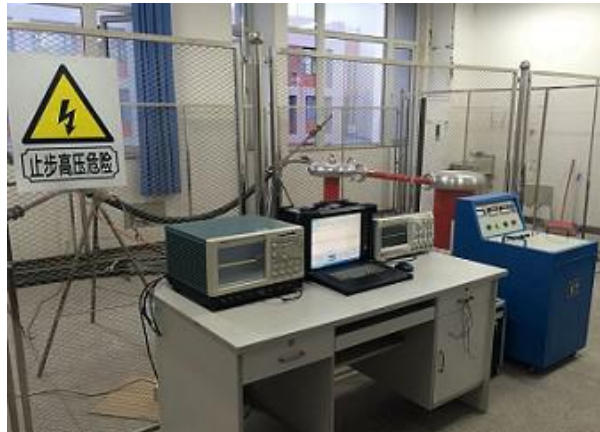
图 2-8 电缆终端局部放电检测试验平台
