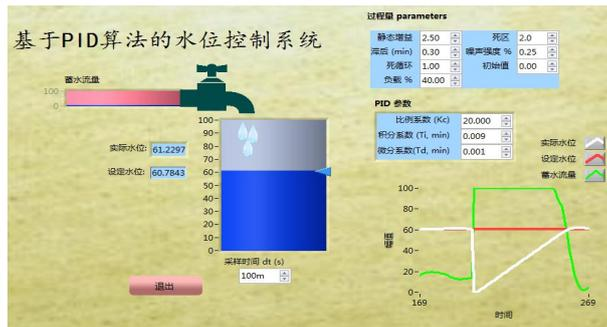
图 2-17 基于 PID 算法的水位控制系统前面板
